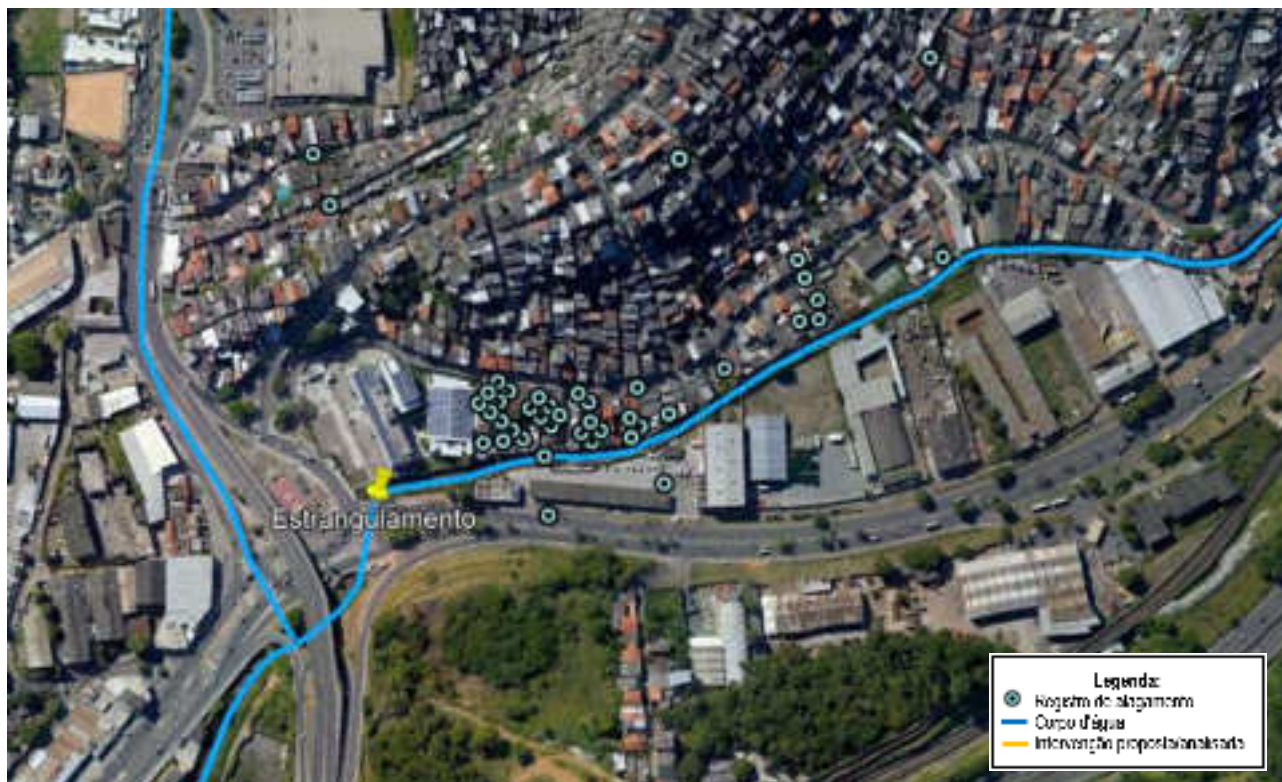
Figura 70 – Estrangulamento na calha principal do Rio Camarajipe
