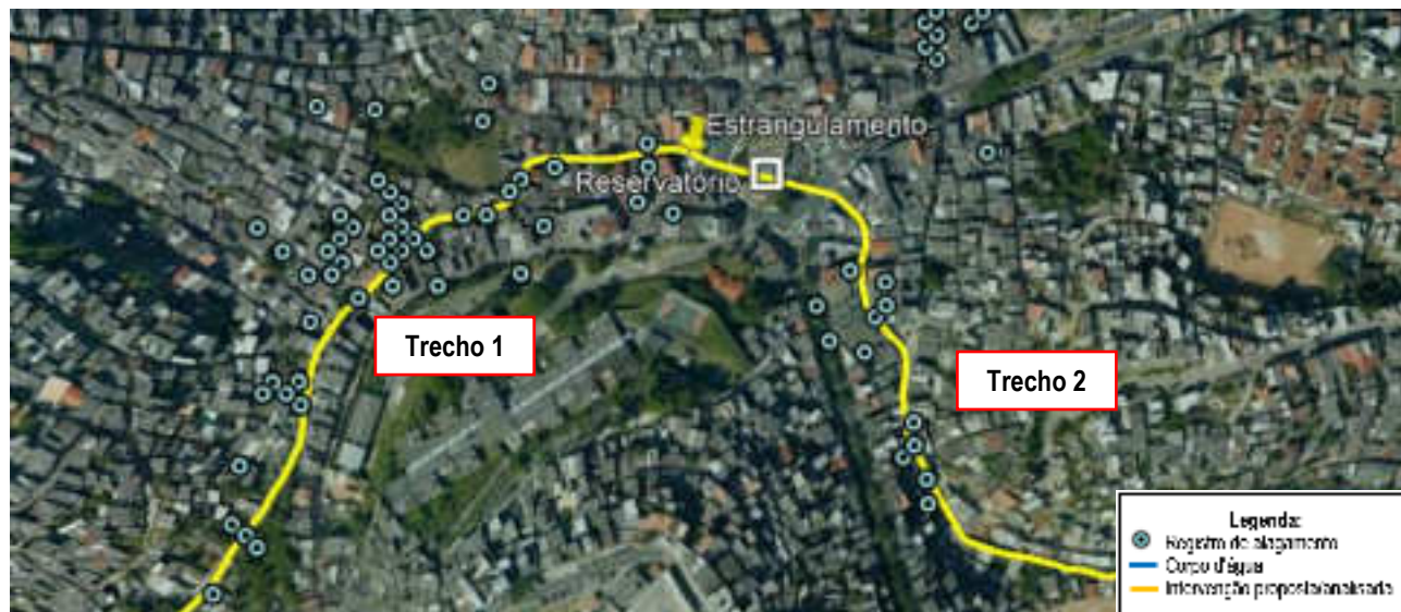
Figura 117 – Trecho do rio Saboeiro, com estrangulamento e insuficiência da seção
