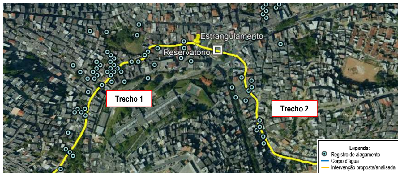
Figura 62 – Trecho do rio Saboeiro, com estrangulamento e insuficiência da seção
