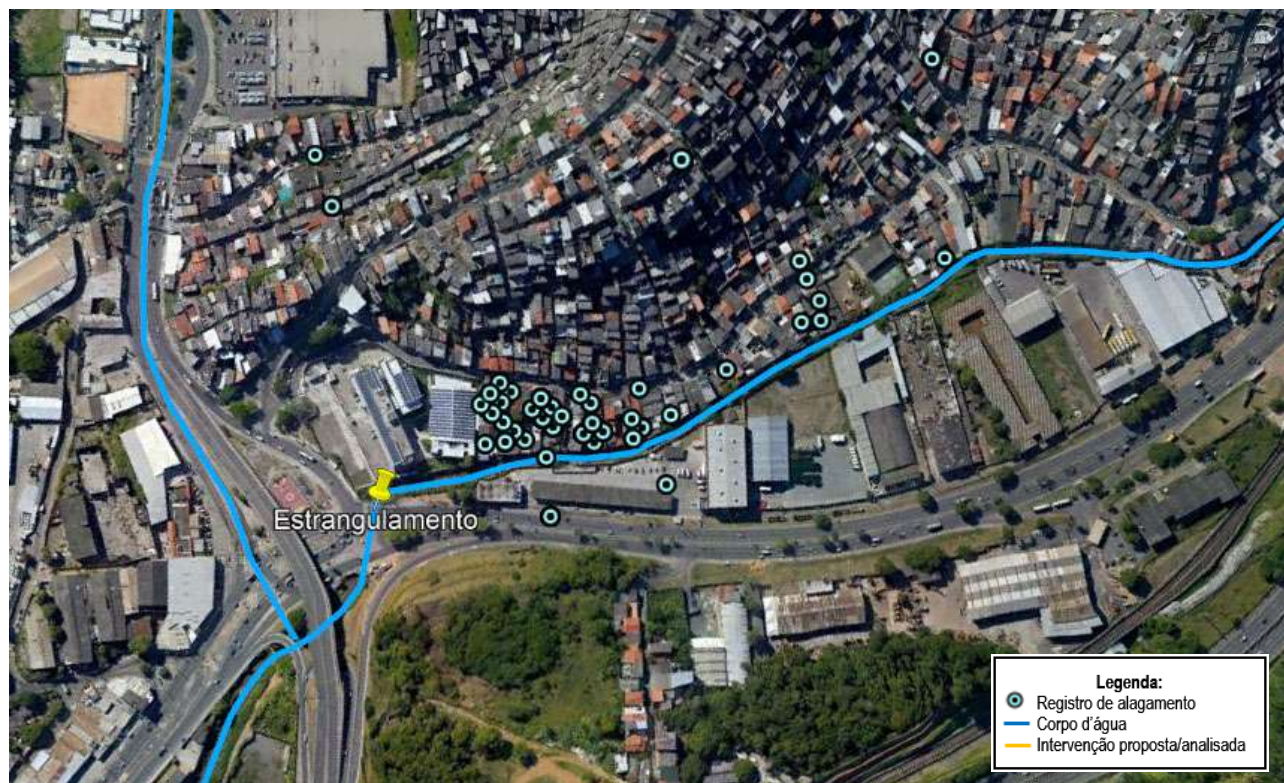
Figura 15 – Estrangulamento na calha principal do Rio Camarajipe
